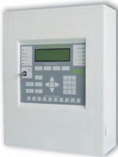
Central inteligente de control de incendios con capacidad para una tarjeta AE/SA-CTL de 2 bucles de 125 equipos cada uno, a los que se conectan los detectores, pulsadores, módulos de maniobras, de control y demás elementos que configuran la instalación. Capacidad de control de 250 equipos.
