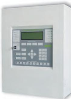
Central inteligente de control de incendios con bus para la conexión de 1 a 4 tarjetas AE/SA-CTL. Cada tarjeta controla dos bucles algorítmicos bidireccionales, con capacidad de 125 equipos cada uno, a los que se conectan los detectores, pulsadores, módulos de maniobras, de control y demás elementos que configuran la instalación.
